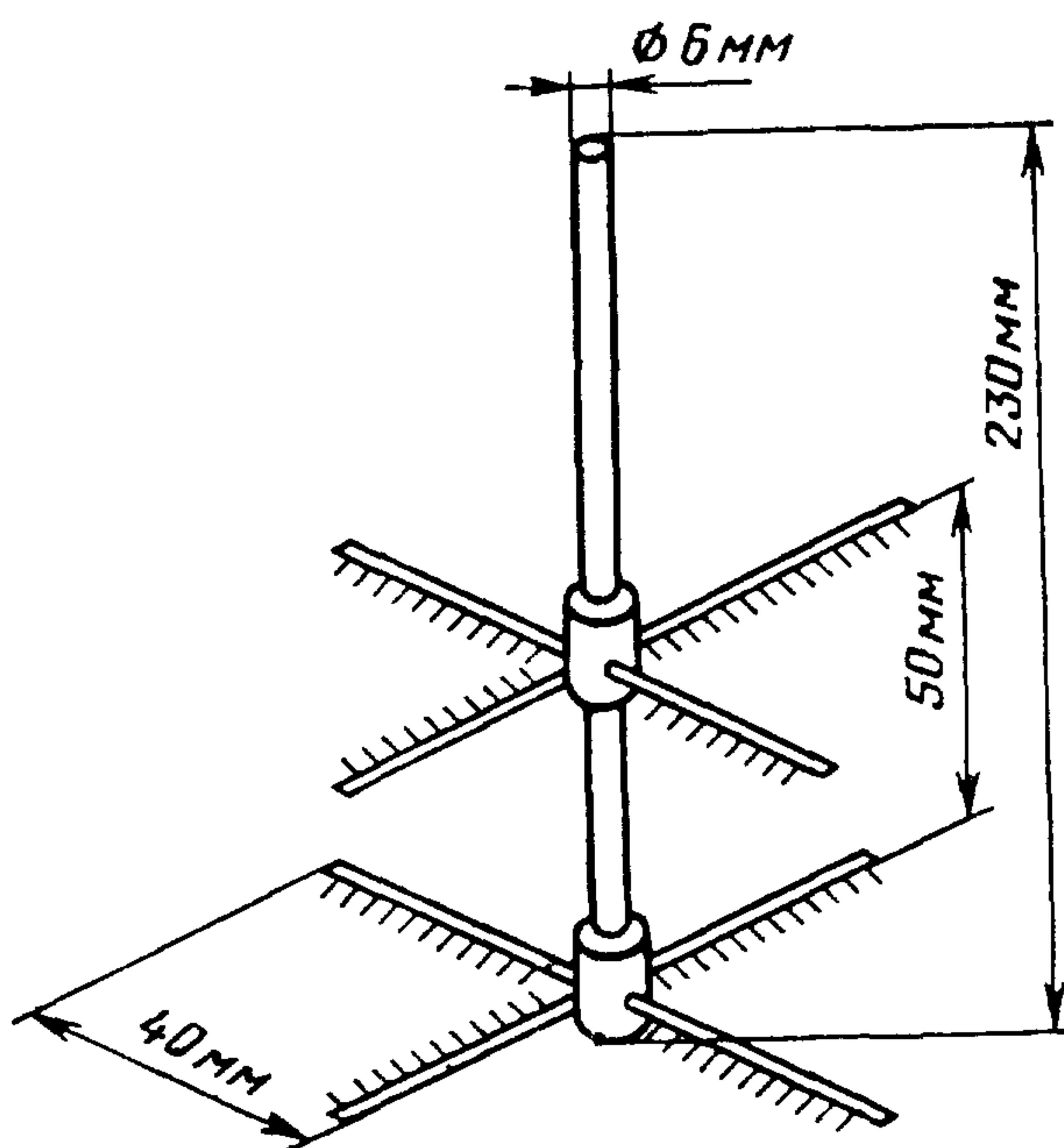
быть ниже уровня воды на 50 мм. По истечении 10 мин рамочку с элементарными пробами вынимают и встряхивают пять раз вдоль элементарной пробы для удаления лишней влаги. Элементарные пробы пинцетом снимают с рамочки, помещают во взвешенные бюксы и взвешивают с погрешностью не более 0,01 г.
